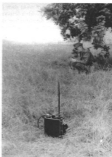
Abb. 5 Teleport IV im Geländeinsatz mit abgesetztem Mikrofon-Lautsprecher
