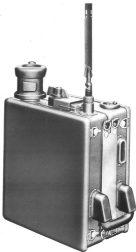
Abb. 1 Teleport IV mit Zerhacker-Stromversorgung, betriebsfertig
